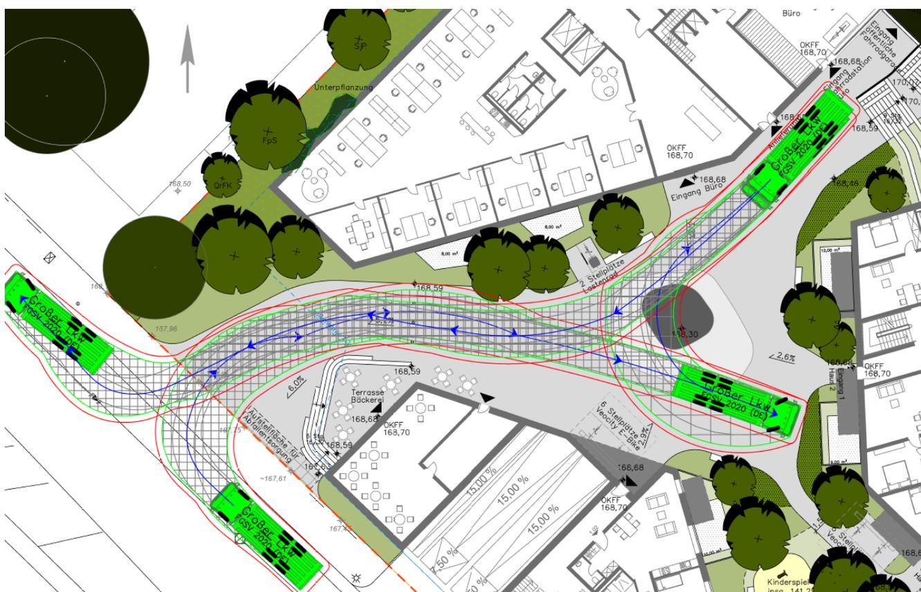
**Bild 18:** Dynamische Schleppkurve eines großen 3-achsigen Lkw zur Überprüfung der Befahrbarkeit des Innenhofes
